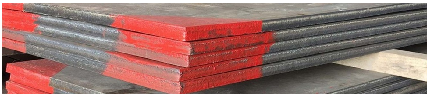
CCO LISO · SUPERFÍCIE SEM CORDÕES NEM TRINCAS
